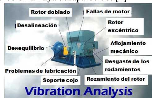
Figura 3. Causas de vibraciones
