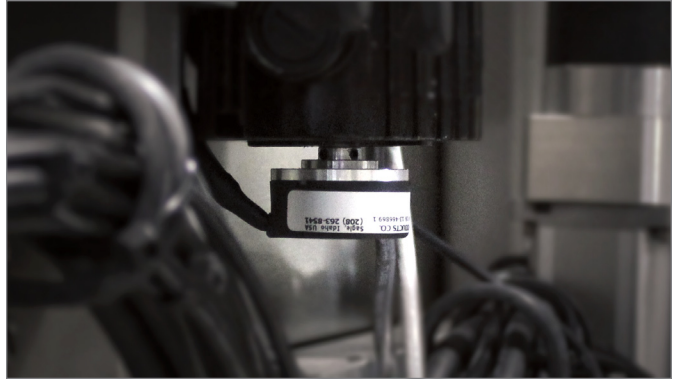
Encoder Incremental Modelo 15 en uso en una etiquetadora en línea
