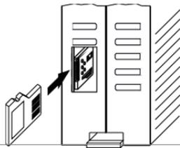
Introducción de la microSD card o de la microSDHC en la ranura lateral. MÁX 32 GB. Conector de tipo push-push.
