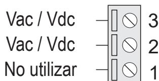
La alimentación se debe conectar a los bornes 2 y 3 o alternativamente se puede utilizar el accesorio Z-PC-DINAL para alimentar a través del conector IDC10 trasero. La tensión de alimentación debe respetar los datos de la placa del dispositivo.
