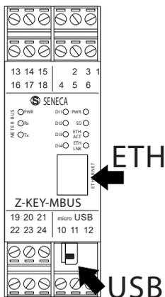
El módulo cuenta con una toma RJ45 en el panel frontal. La figura muestra dónde se debe introducir el conector ethernet RJ45. Para más información consultar el **MANUAL DEL USUARIO**.
