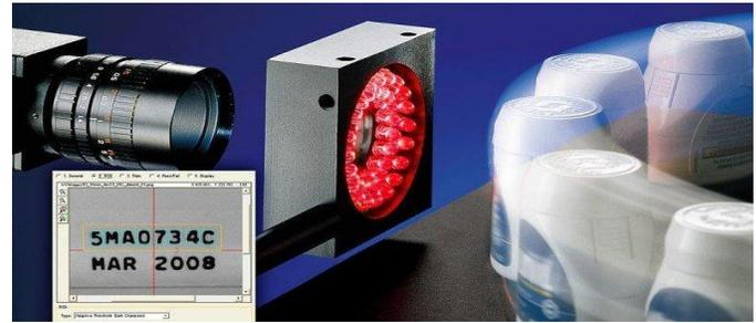
Figura 2. Cámaras de visión artificial
