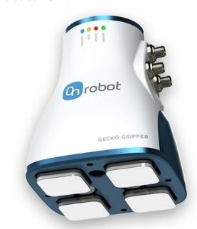
Debido a que se basa en fuerzas intermoleculares en lugar de fricción para agarrar objetos, permite a los robots recoger elementos planos actualmente el dominio de las pinzas de vacío. Pero los sistemas de vacío, que dependen del aire
