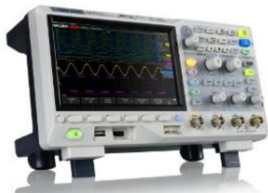
Con los osciloscopios de almacenamiento digital tradicionales, el procesamiento y visualización de datos de forma de onda se realizan dentro de la CPU
