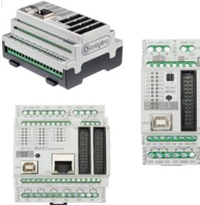
**PLC's de grado industrial compatible 100% con Arduino**
