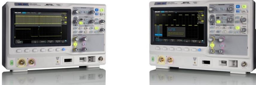
Los osciloscopios Súper Fósforo Serie SDS2000X de SIGLENT están disponibles en anchos de banda de 70 MHz, 100 MHz, 200 MHz y 300 MHz, con una frecuencia de muestreo máxima de 2 GSa / s, y vienen con una longitud máxima de grabación de 140 Mpts. Se puede acceder a las funciones más utilizadas con su diseño de un solo botón fácil de usar.
