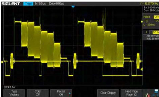
Pantalla de graduación de intensidad de 256 niveles en la forma de onda.
